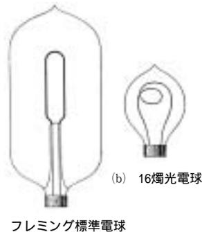
第2図 フレミング標準電球と16燭光電球
