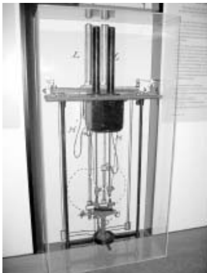
写真1 ブラッシュのアーク灯、1メートルもの大きさがあつた (電極間隔の制御が必要であつた)
