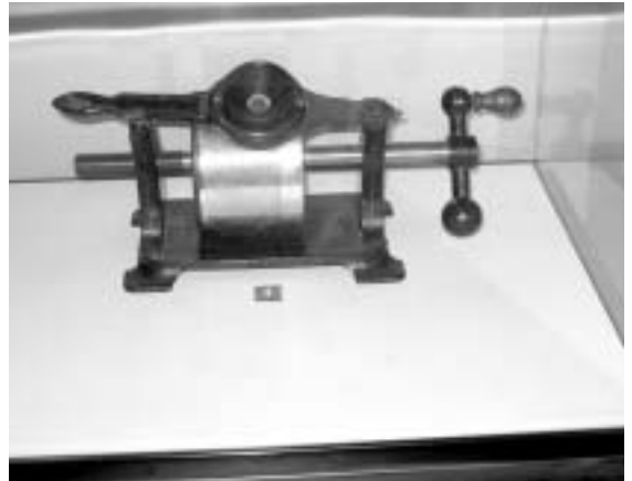
写真3 蓄音器 こんな簡単な構造で音声を録音、再生できた
