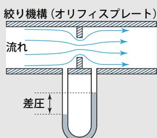
図1 差圧式流量計の動作原理
