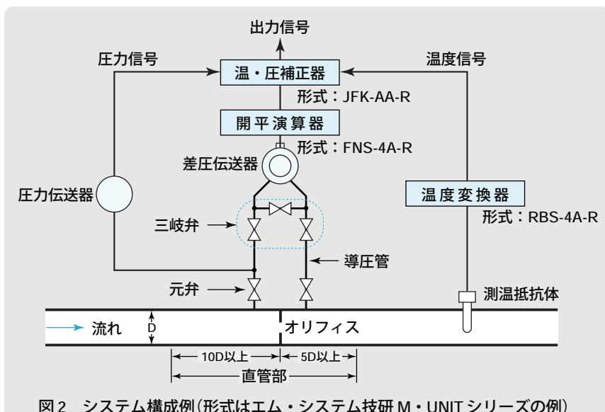
図2 システム構成例(形式はエム・システム技研M・UNITシリーズの例)
